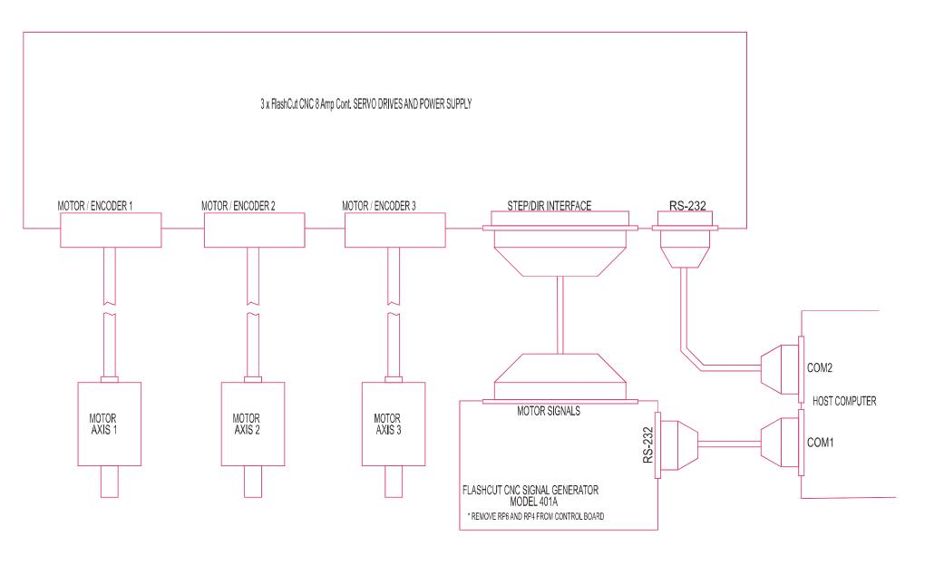
FlashCut CNC- THREE AXES CNC SERVO CONTROL SYSTEM
